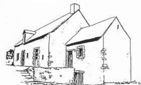
6 - Champagne Mancelle. Exemple d'habitat adapté au terrain. Ouvertures appareillées. Annexe construite en pignon. Linteaux de bois aux portes. Muret maçonné, fréquent jusque dans le Bocage Sabolien.
