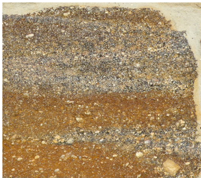
IMAGE 2 – Fragment de roussard montrant plusieurs lits de granulométrie plus ou moins grossière et de ciments, riches en fer de couleur rouille ou en manganèse de couleur brun foncé à noire
