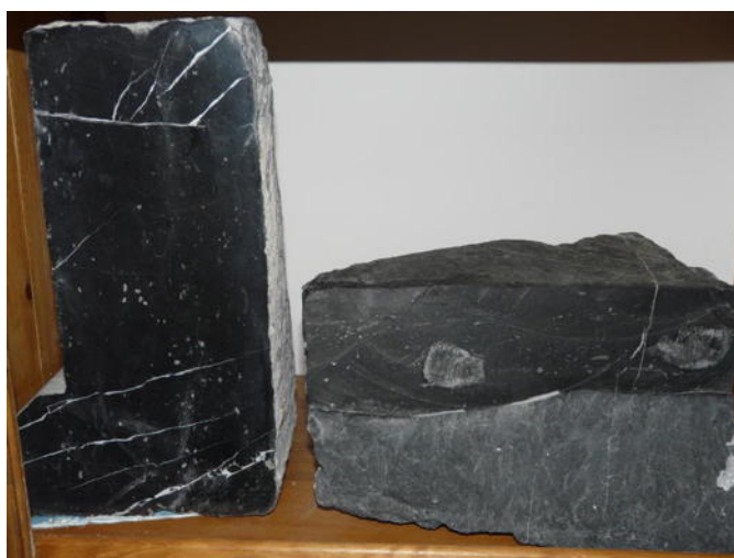
IMAGE 1 – Blocs en marbre de Sablé, à gauche face polie, à droite présence de fossiles
