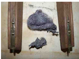
Brossage manuel paille de fer 00 ou 01 Plus fin et plus précis que la brosse métallique, il nettoie aussi le bois.
