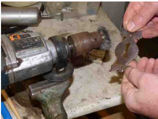
Perceuse électrique bloquée sur un étau et fichée d'une petite brosse métallique, c'est un outil que tout le monde possède.
