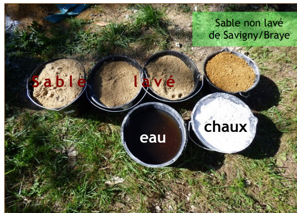
différents types de sables, eau de pluie et chaux
