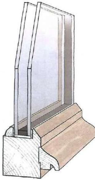
Feuillure du châssis existant élargie pour poser un double vitrage (si bâti suffisamment épais) ou fabrication d'un nouveau châssis. S'assurer que le châssis ancien peut supporter le poids du double vitrage.
