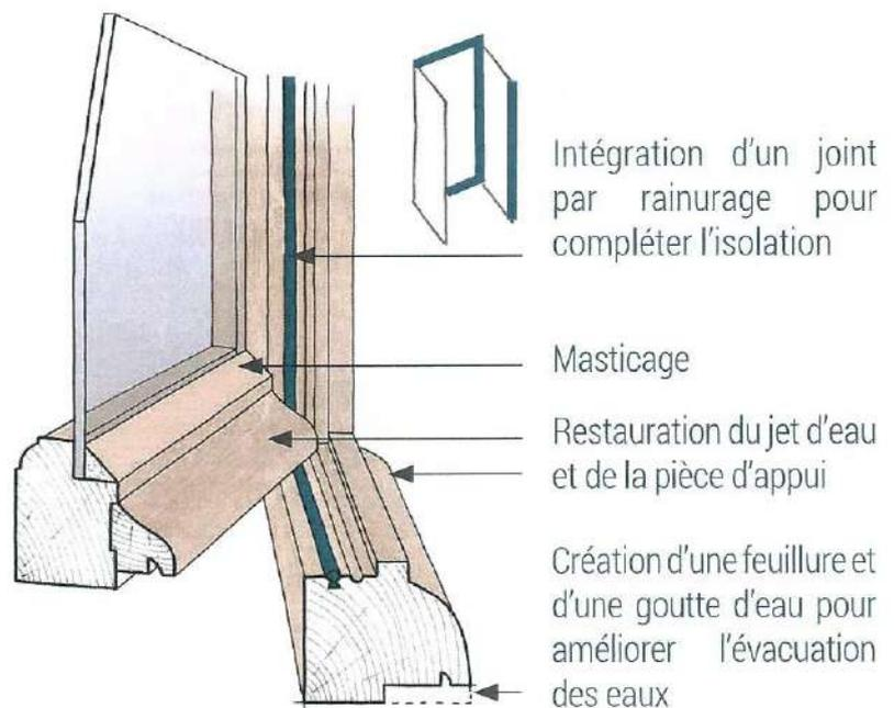
Intégration d'un joint par rainure pour compléter l'isolation
