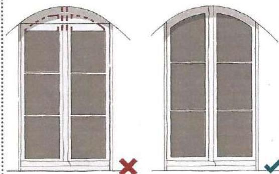
Afin de maintenir le plus de luminosité possible, il est préférable que le dessin de menuiserie s'adapte à celui de la maçonnerie.
